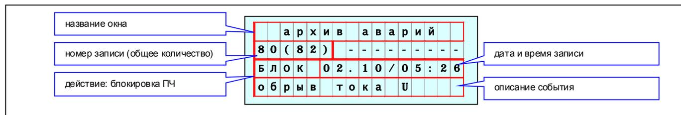
Рисунок 3.1.1. Отображение окна архива аварий.
